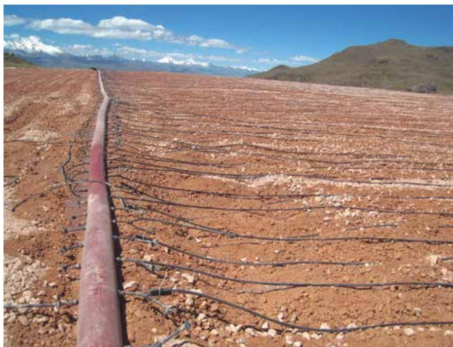
Las celdas de riego incluyen tuberías que abastecen de solución a las mangueras para el riego.
