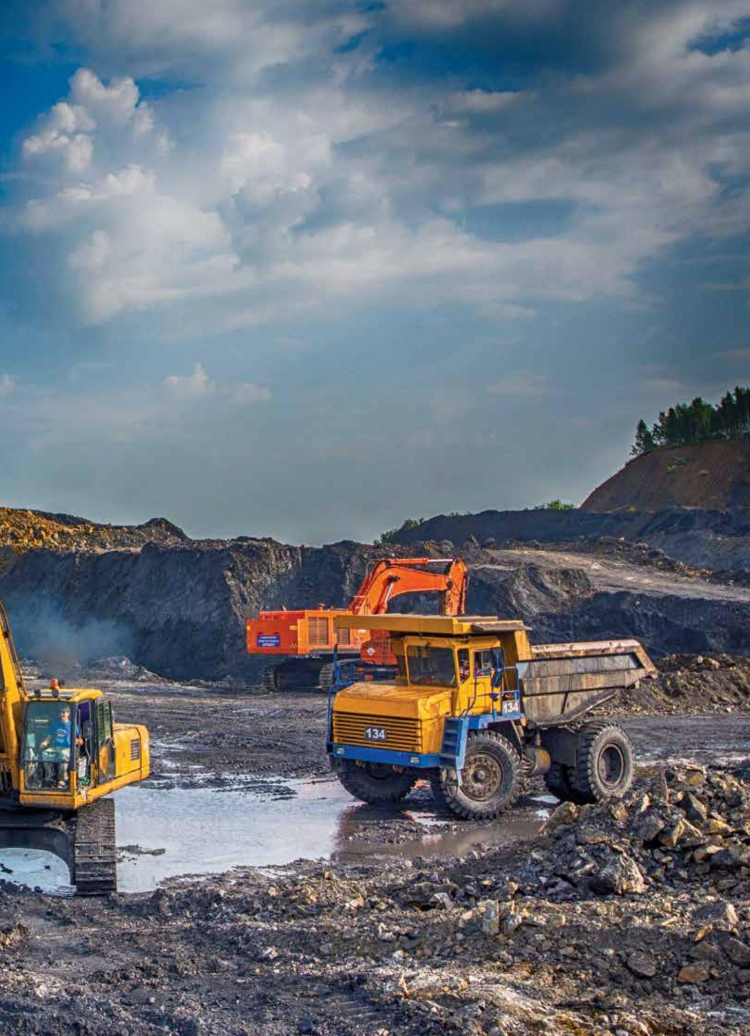
Una operación a tajo abierto supone la extracción de todo el material de la zona donde se halla el mineral.
