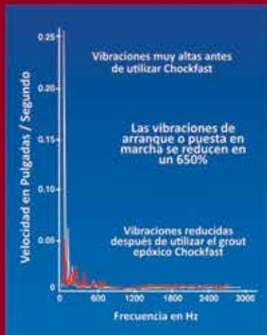
**EXCELENTE REDUCCIÓN DE LAS VIBRACIONES CON LAS EFICIENTES RESINAS EPÓXICAS CHOCKFAST PARA CIMENTACIONES DE ALTA PRECISIÓN**
