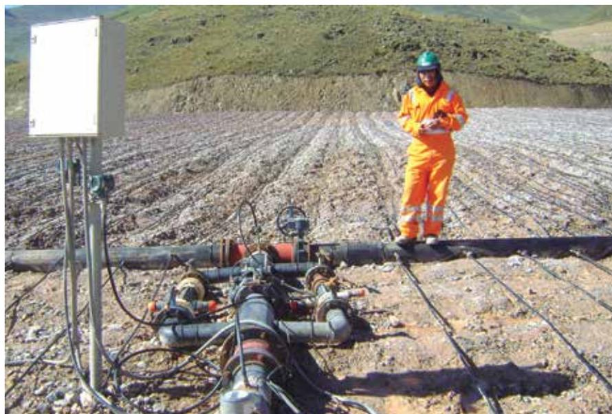
Antes de su funcionamiento, se realizan pruebas de monitoreo al sistema de riego lixivador.
