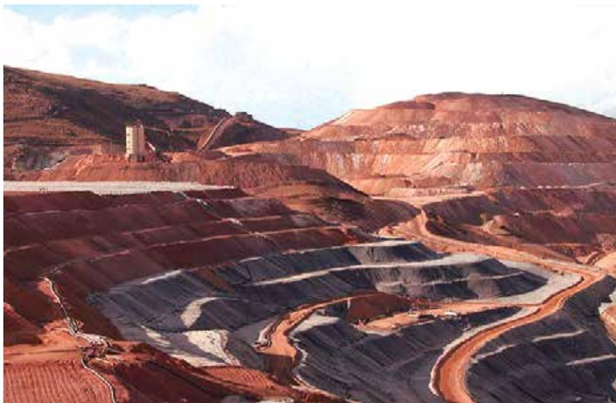
Después de explotar el tajo, la carga viaja en fajas o camiones para luego ser depositadas sobre las capas de lixiviación.
