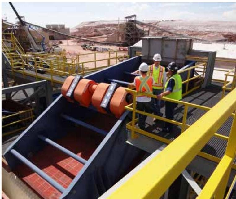
Weir vende equipos de la marca Enduron, una línea de zarandas fabricadas a medida.
