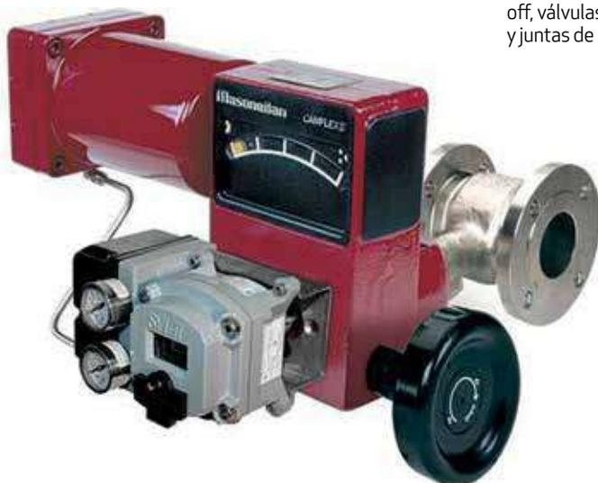
“La válvula Camflex II tiene un diseño de tapón excéntrico donde el obturador y el asiento solo tienen contacto cuando la válvula está cerrada”, explicó Mario Ginocchio.
