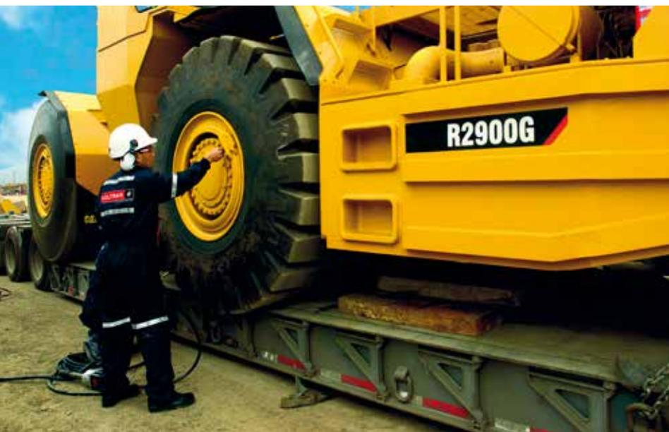
La tecnología TPMS de Soltrak determina la temperatura y presión exacta de las llantas.
