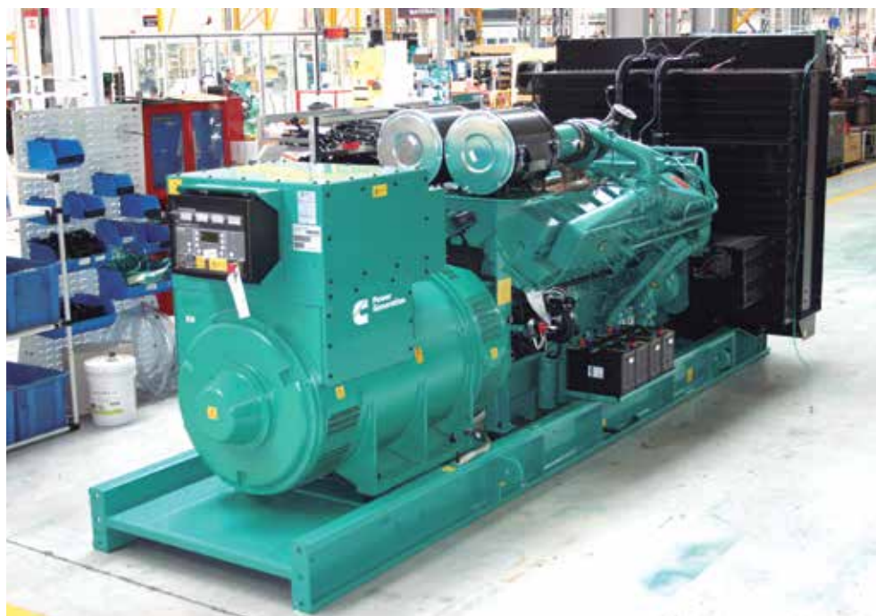
Los componentes más importantes del grupo electrógeno son el motor y alternador.
