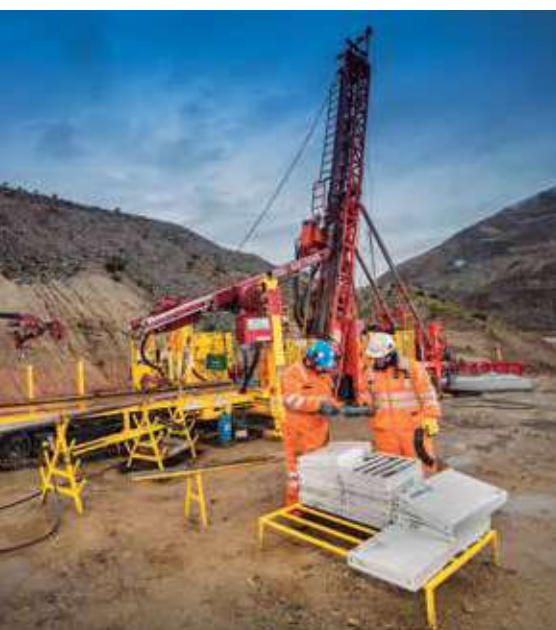
Los equipos de perforación permiten llegar a profundidades mayores a 2,000 metros para obtener las muestras.
