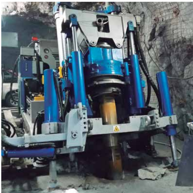
“La Perforadora SBM 400 SR (Slot Raises) está diseñada para mejorar la productividad minera y reducir sus riesgos”, detalló Tumi.
