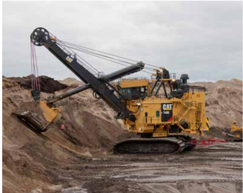
Ferreyros ofrece su pala eléctrica Cat 7495 que puede mover hasta 140,000 toneladas al día.
