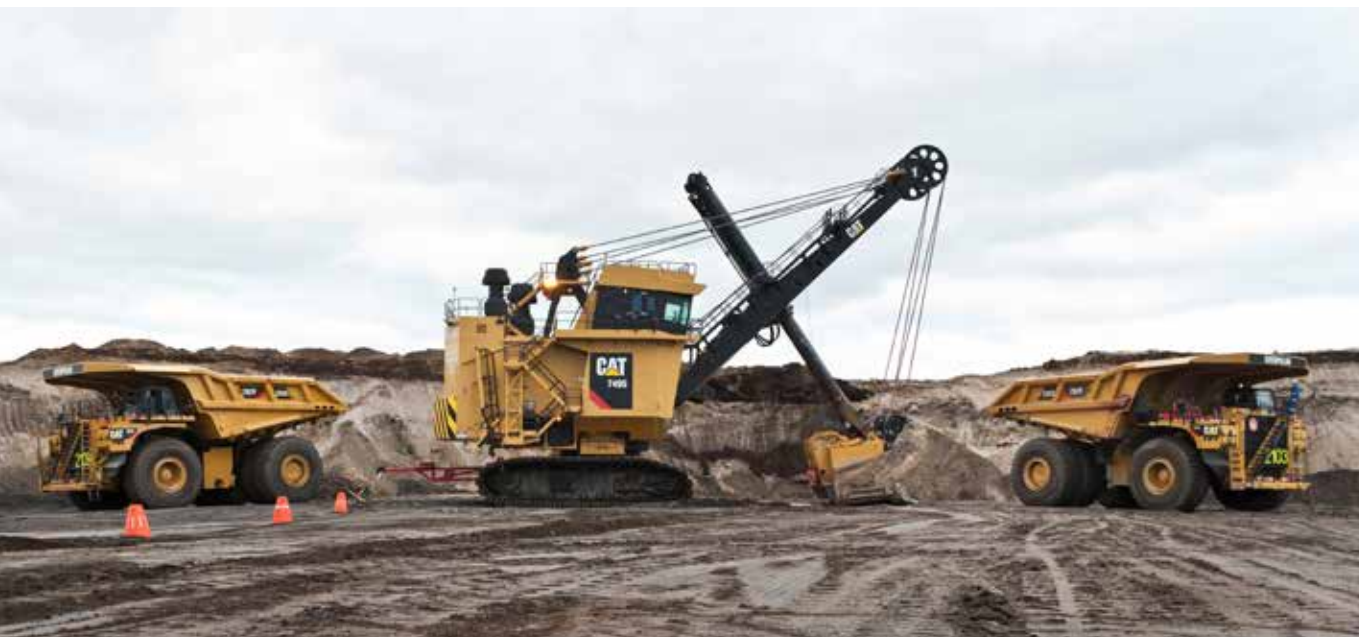
Estos equipos de Caterpillar han incorporado en su evolución el sistema hydracrowd.
