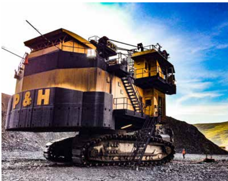
La pala P&H 4100XPC-AC cuenta con una carga útil nominal de 110 toneladas métricas.
