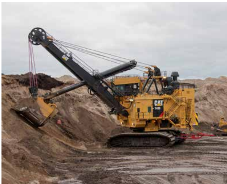
Ferreyros ofrece su pala eléctrica Cat 7495 que puede mover hasta 140,000 toneladas al día.
