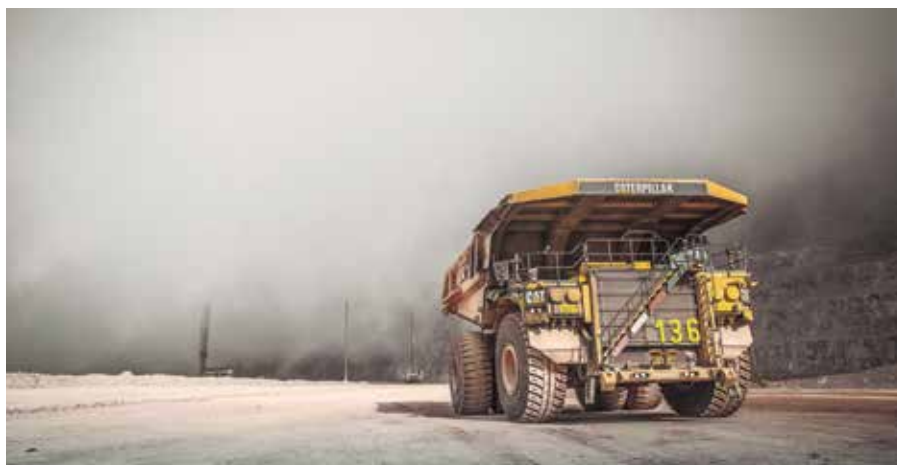
Camión 797F, cuenta con filtro de auto limpieza y centrífugo.
