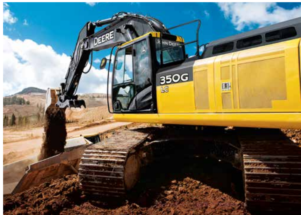
Por su parte, la excavadora 350 GLC resume 120 kNm de torque y 271 HP de potencia.
