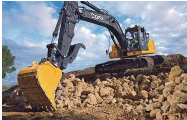
La excavadora 210 GLC ofrece un torque de 68 kNm y una potencia de 159 HP.
