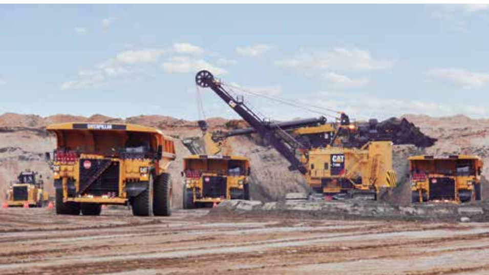
Los camiones CAT 797F se complementan con la pala CAT 7495.
