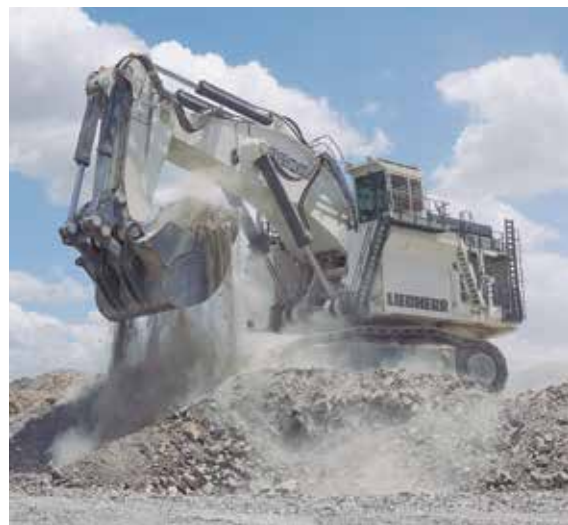
La pala R9800 resalta una capacidad de 800 toneladas, permitiendo optimizar el proceso de carga hacia los camiones.
