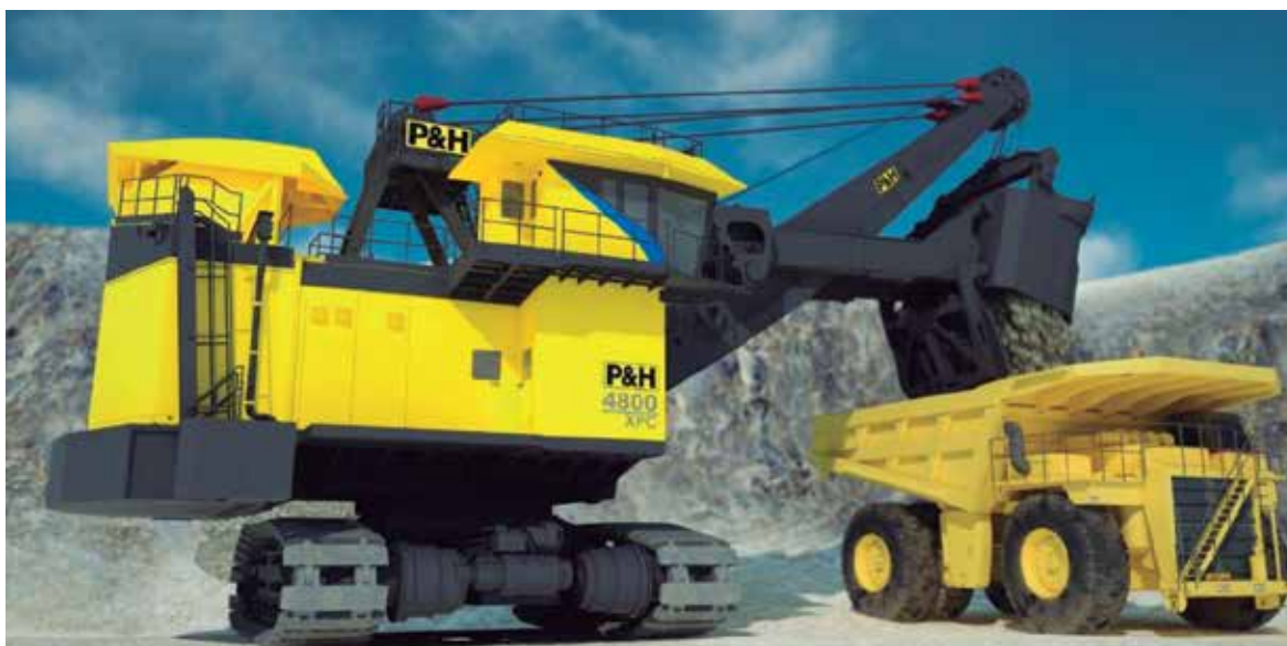
La pala P&H 4800XPC es capaz de cargar en solo 03 pases camiones de 400 toneladas cortas.
