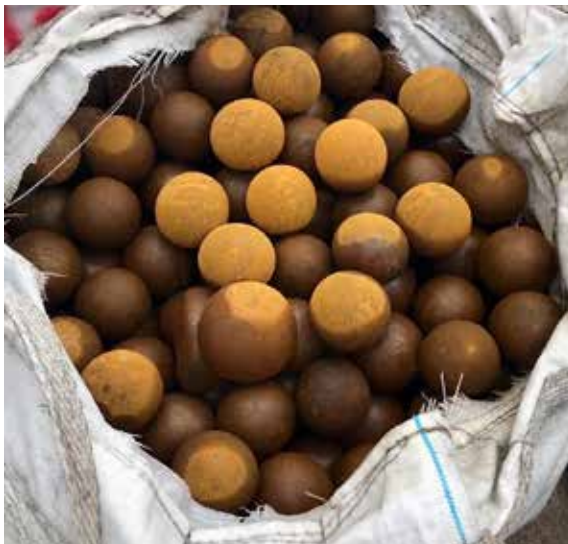
DESCARTE REAL DE BOLAS - MOLINO SAG MINERA ZIJIN
