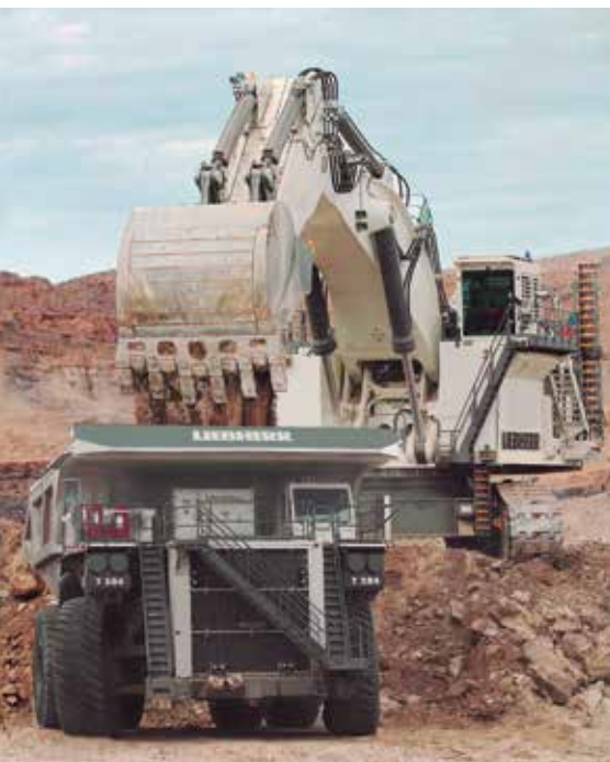
El camión minero T 284, de 400 toneladas, es utilizado actualmente en minas de tajo abierto a gran altura.
