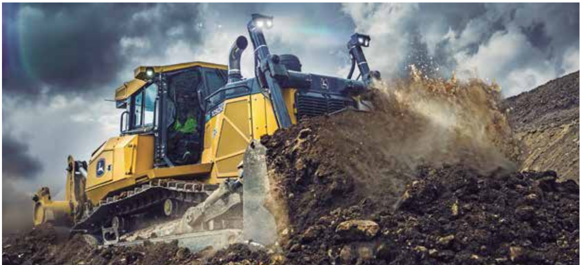
Gracias a su transmisión hidrostática, el bulldozer 1050K logra un control de velocidad variable y giros de 360°.
