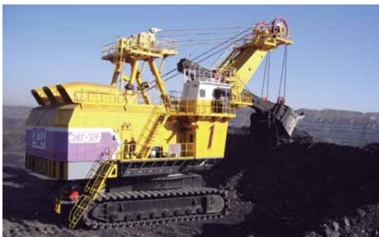
Pala eléctrica IZ-KARTEX, preparada para sostener 65 m 3 en la cuchara.
