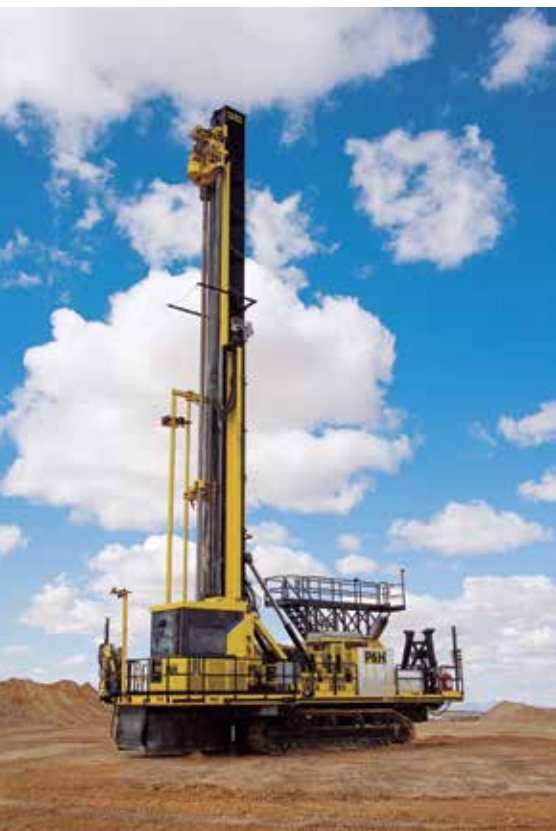
Asimismo, cabe resaltar que la perforadora P&H 77XR ostenta una mejora del 12% en el tiempo del ciclo de perforación.
