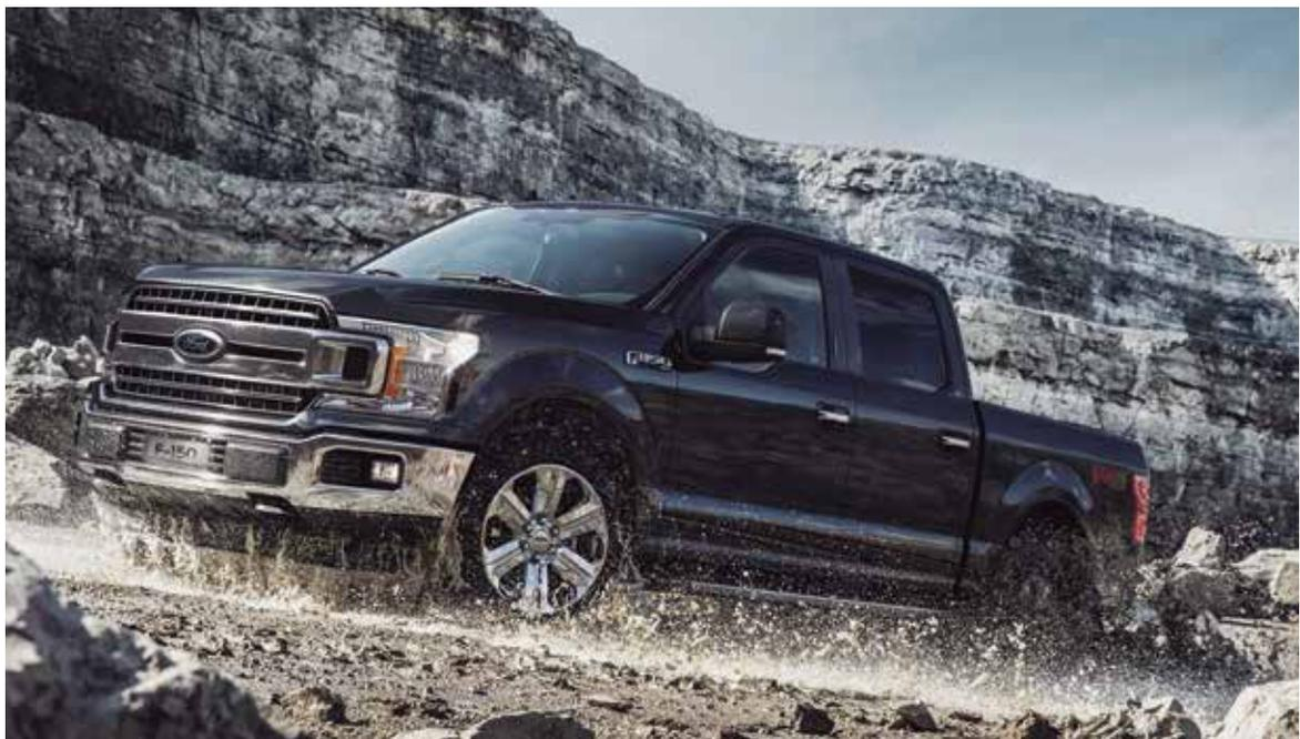
Ford Perú incorporó la versión XLT de Ford F-150, ideal para la industria minera, que incluye un motor de 3.3L V6 de 290 CV y 359 Nm de torque.
