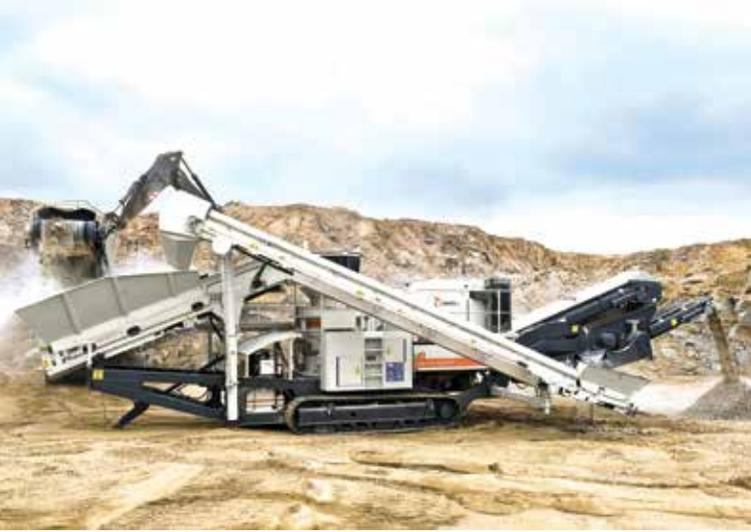
Dentro de la línea Lokotrack, destaca la chancadora de cono modelo LT200HP.
