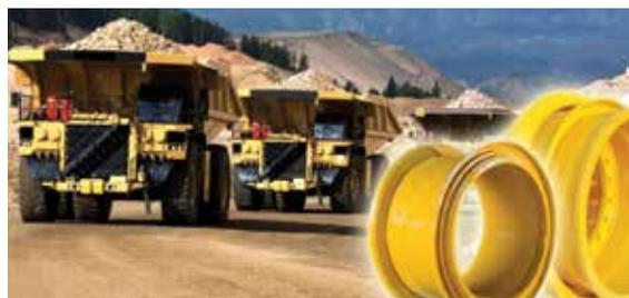
fuerzos a las zonas críticas del aro para asegurar **el perfecto sellado y compatibilidad entre sus componentes, evitando de esta manera pérdidas de aire y consecuentemente alargando la vida útil del neumático.**
